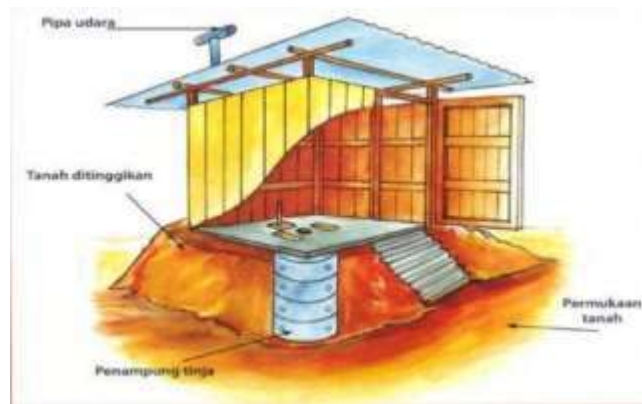
Gambar 2. 1 Konstruksi jamban dengan Permukaan ditinggikan
