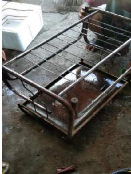
Gambar 3 Proses pembuatan kerangka alat dari besi yang digunakan untuk meletakkan box sterofom,
