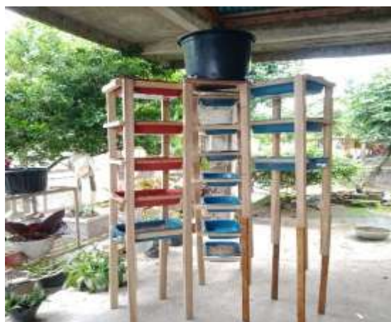
Gambar 2.2 Multiple Tray Aerator dengan saringan pasir
