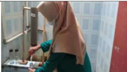
Proses pengambilan sampel air setelah didetensi dengan karbon aktif cangkang sawit didalam penyaringan selama 30 menit
