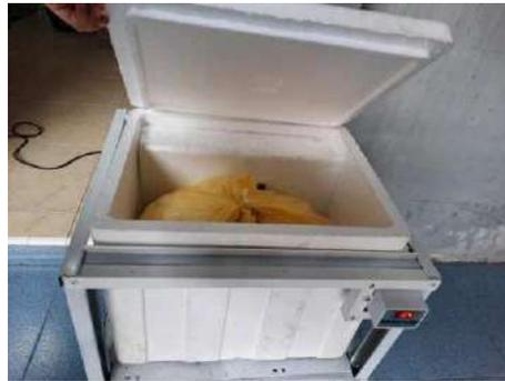
Gambar 4.4 Pengujian Sampel Pada Alat Cold Storage Sederhana
