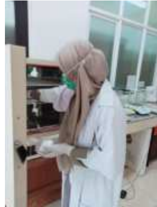
Keringkan kertas saring dalam oven pada suhu 103-105^{\circ}\text{C} selama 1 jam
