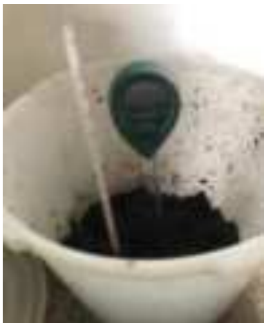
Pengecekan suhu kompos menggunakan thermometer dan soil meter untuk pH dan kelembaban kompos
