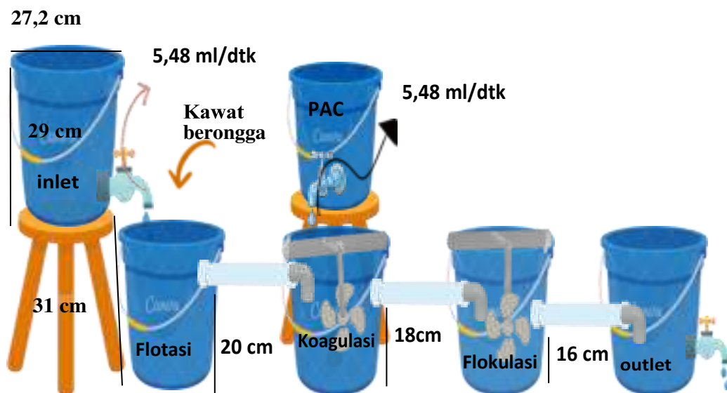
Gambar 2. Rangkaian Alat Pengolahan Air Limbah
