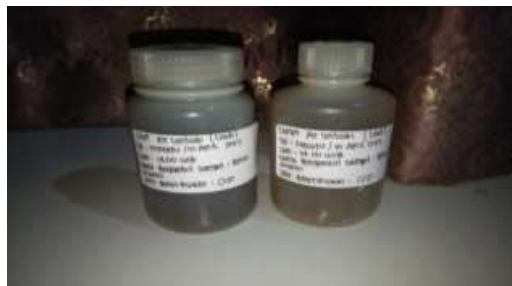
Sampel COD pada Inlet dan Outlet IPAL Sistem Lagoon TPA Regional Payakumbuh
