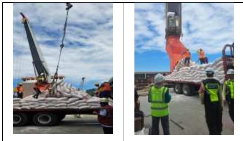
Gambar 5. Pekerja Sedang Menyusun Barang Muatan Pada Tali Sling
