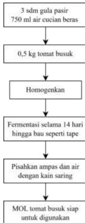
Gambar 3. Alur Pembuatan MOL Tomat Busuk
