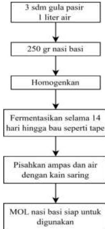
Gambar 4. Alur Pembuatan MOL Nasi Basi
