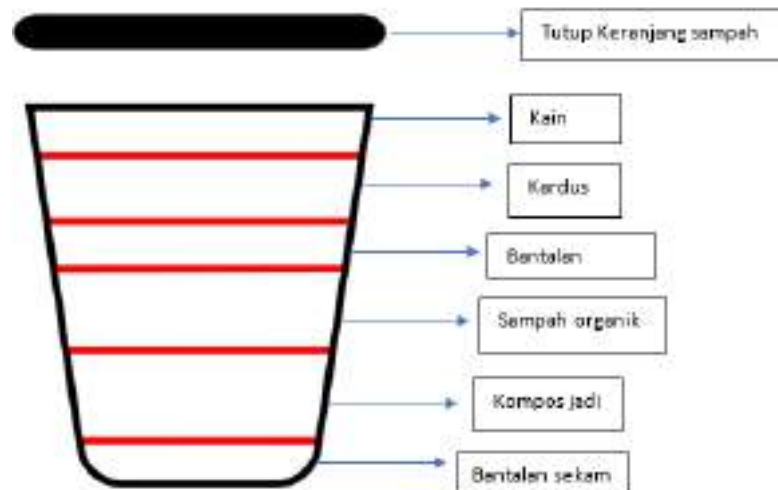
Gambar 1. Susunan Komponen Keranjang Takakura 13
