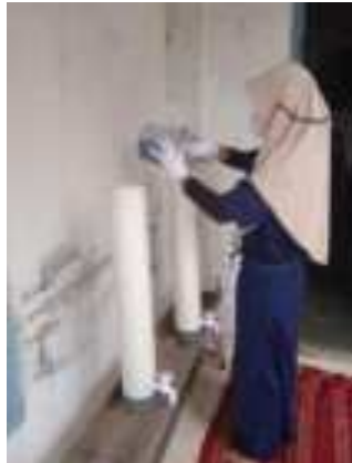
Media karbon aktif dimasukkan ke dalam masing-masing pipa yang telah dimodifikasi, dengan ketebalan 20, 40 dan 60 cm yang diukur dengan meteran
