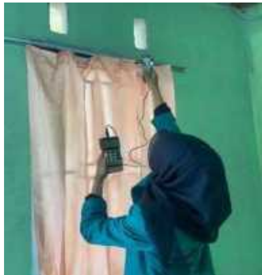
Melakukan Pengukuran Laju Ventilasi Di Kamar Tidur Responden Menggunakan Alat Anemometer
