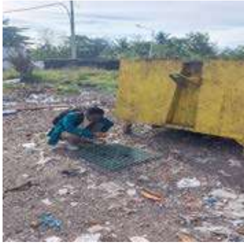
Melakukan pengukuran di sekitar tempat pembuangan sampah di area pasar dengan fly grill.
