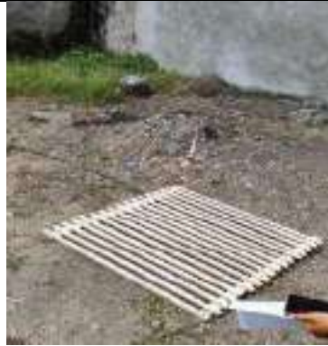
Persiapan Pengukuran tingkat kepadatan lalat dengan meletakkan flygrill di titik lokasi pengukuran
